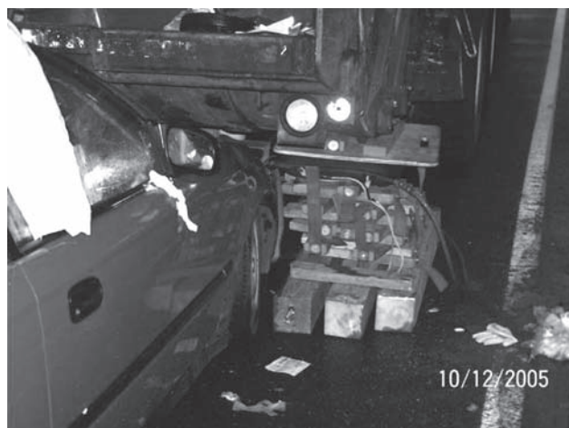
FIGURA 2. Se utilizaron 3 plataformas de sujeción y bolsas de aire con presión elevada para levantar la parte trasera del camión y separarla de la parte delantera del coche. Además de la plataforma que se observa en la imagen, se colocaron plataformas idénticas en el lado izquierdo del camión y bajo éste inmediatamente por delante del parachoques del coche.
