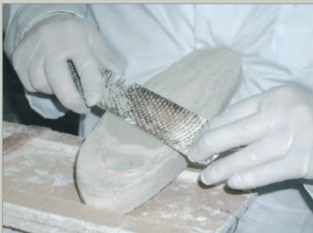
Fig. 3. Rectificación del molde positivo del pie.
